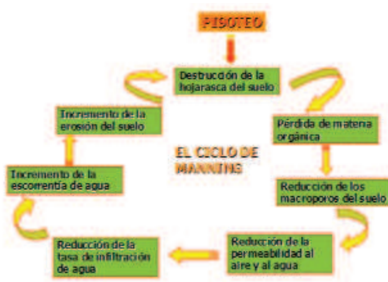
Figura 3. El Ciclo de Manning explica de forma sencilla cómo se inicia un proceso de erosión en el suelo, a partir de la destrucción de la hojarasca, debida al pisoteo (Manning, 1979).
