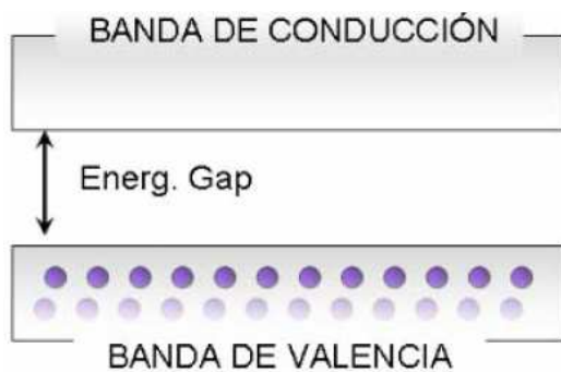
Figura 1. Relación de dispersión y diagrama de bandas de energía de semiconductores: la banda de valencia está completamente ocupada por electrones mientras que la de conducción está vacía.
